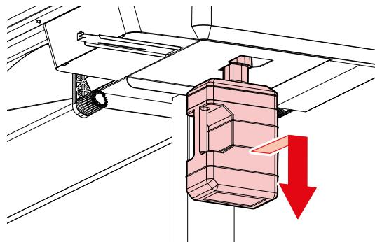
**6** Prenda a tampa ao tanque de tinta residual sem tampa e use fita adesiva para evitar vazamento de tinta residual.
