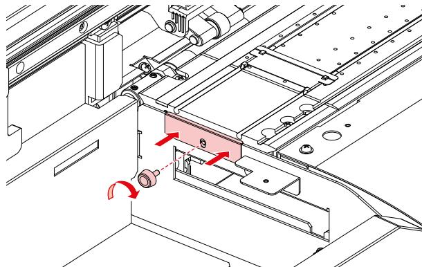
**6** Coloque a tampa de manutenção (lado superior esquerdo).
