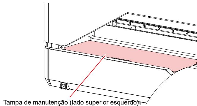
**2** Remova o parafuso lateral e retire a tampa do suporte de mídia.
