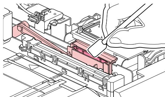
**7** Instale um novo limpador.
